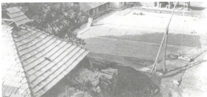
Sušenie surových tehál v starej tehelni
